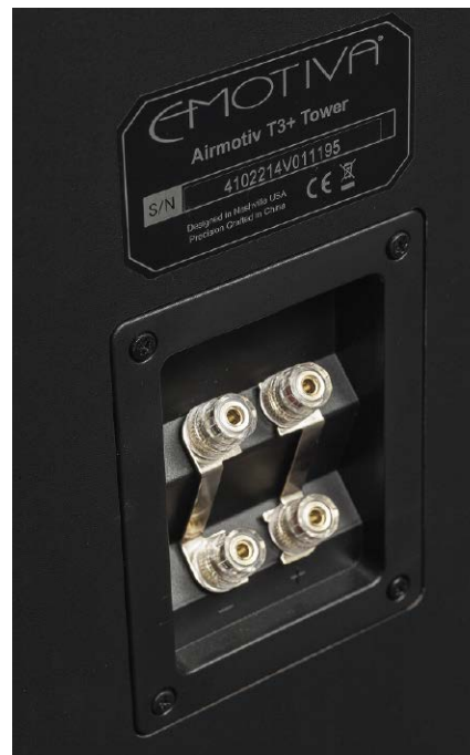
Terminal przyłączeniowy jest podwójny, chociaż najpospolitszego gatunku, ale spełni swoją podstawową rolę. Przy podłączeniu pojedynczym (99% przypadków) warto wymienić zwory, a jeszcze lepiej przylutować obydwie pary kabli (wewnątrz kolumny) do jednej (dowolnej) pary zacisków.
